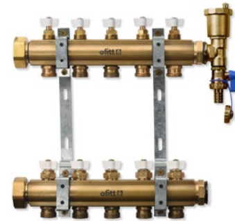
Colector con válvulas de accionamiento manual, válvula de purga y llenado en la impulsión y tapón en el retorno
